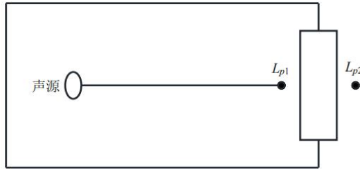
图 5.6-1 室内声源等效为室外声源图例
